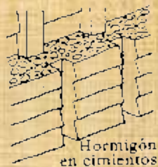
Hormigón en cimientos
